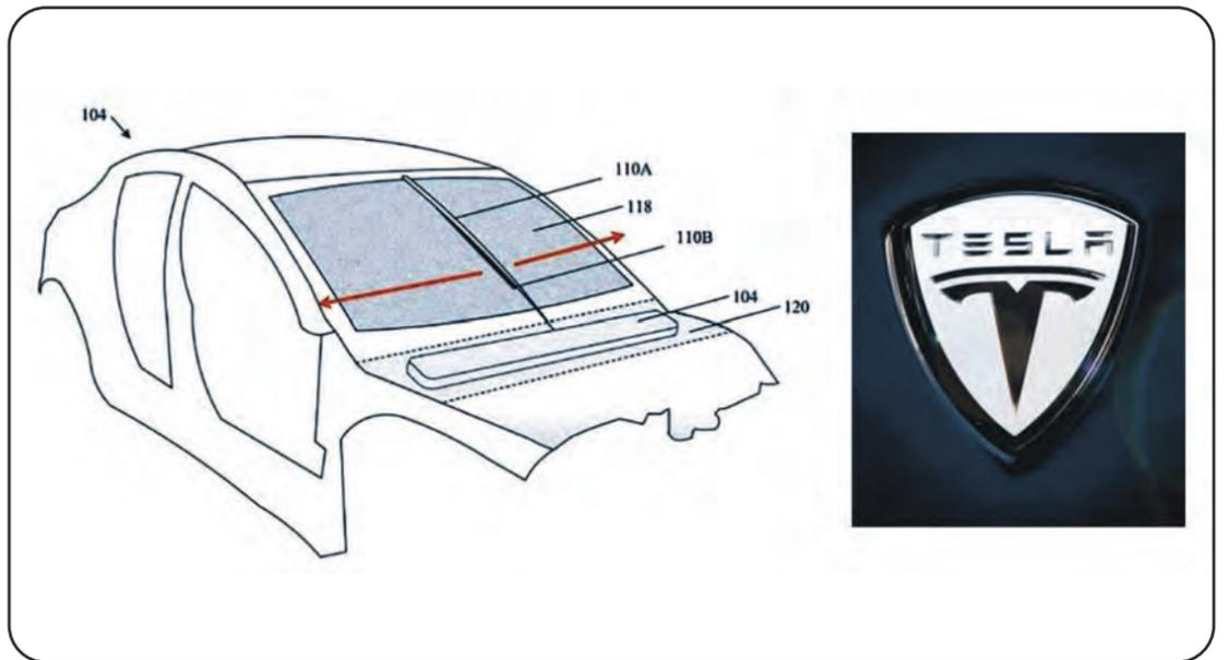
A diferencia de los limpiaparabrisas convencionales, este invento de Tesla ocupa toda la superficie del cristal por lo que en coches como los Model 3, Model S o, sobre todo, el Model X, tiene una especial importancia por la enorme luna frontal que llevan.
