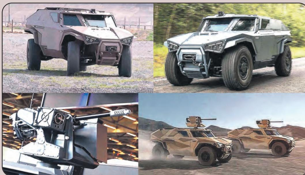
Tiene dos motores (uno eléctrico y otro diésel), se puede controlar a distancia y puede transportar más de dos toneladas de equipo, incluidas las armas. Es incluso transportable y descargable desde una altura baja, sin paracaídas, en avión. Scarabée, que es más pequeño y más rápido que un Humvee estadounidense, es un candidato
